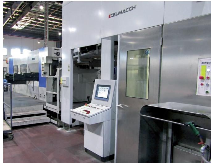
di feeder con cinghie a motori diretti, cambio rapido del lavoro durante la produzione, sistema di raccatura in fibra di carbonio, cilindri anilox in ceramica GTT Apex e trasporto aspirato per la connessione con la fustellatrice automatica Bobst. Best Carton ha selezionato l'azienda italiana non solo per la sua tecnologia avanzata a un prezzo accessibile, ma anche grazie alla scelta delle componenti utilizzate per i suoi macchinari.
